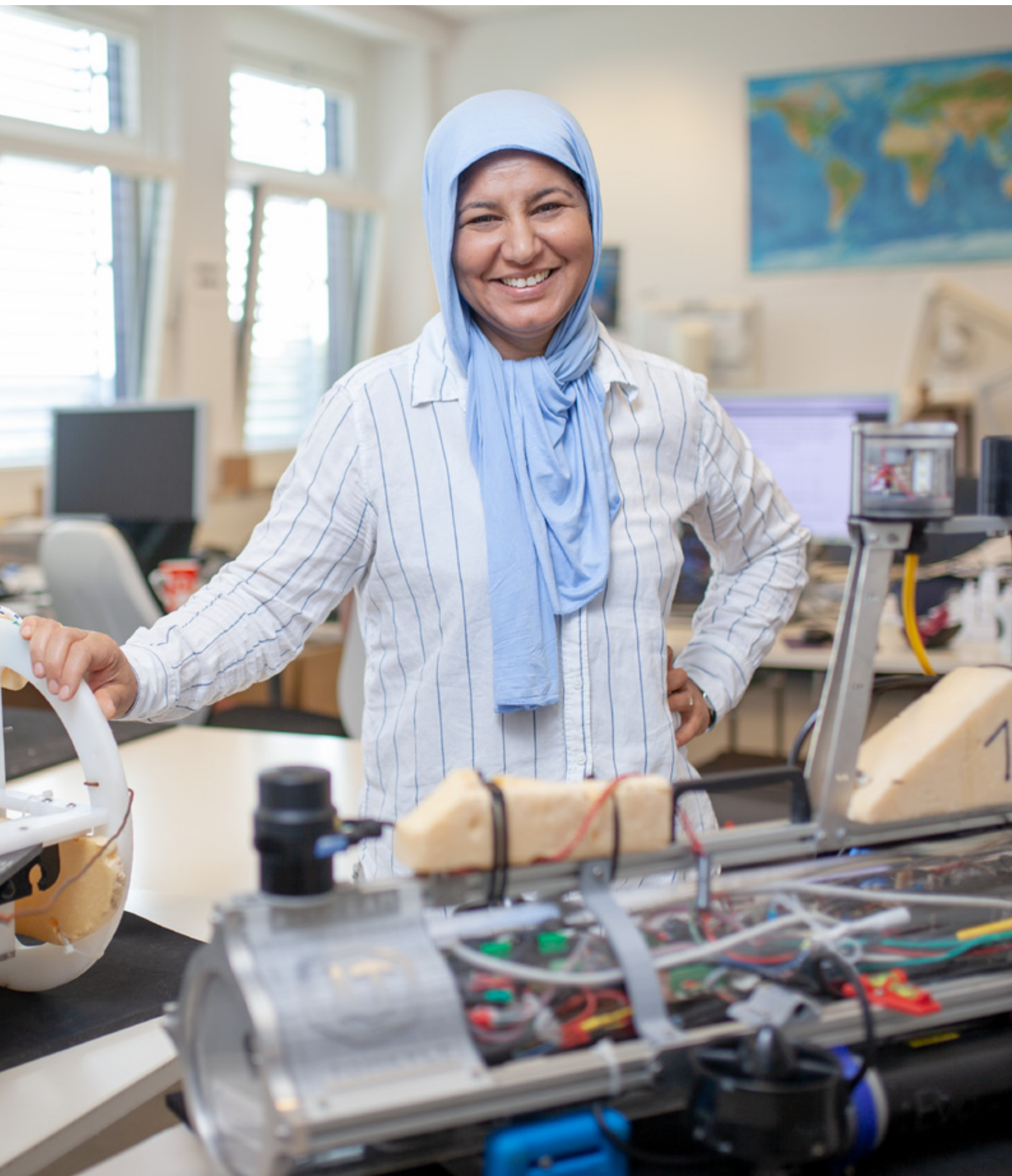
Das Rucksack-AUV ist die zweite Generation von AUVs der FH Kiel nach der Robbe 131. Es soll durch seine Bauweise einen einfachen Einsatz durch eine Person ermöglichen, auch um die Aufnahmen von Messdaten zu Forschungszwecken flexibler zu gestalten.
